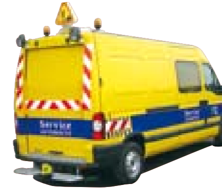
RENAULT MASTER H2 und H3 OPEL MOVANO H2 und H3 NISSAN INTERSTAR H2 und H3 Durchgangsbreite: 1300 mm Durchladehöhe: 1660 mm
