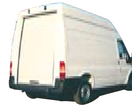
FORD TRANSIT Überhöhe Durchgangsbreite: 1198 mm Durchladehöhe: 1710 mm
