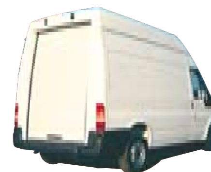
FORD TRANSIT Realzado Ancho de paso: 1200 mm Altura de paso: 1710 mm
