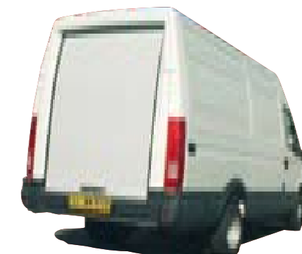
IVECO DAILY H2 Ancho de paso: 1260 mm Altura de paso: 1700 mm
