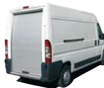
PEUGEOT BOXER H2 CITROEN JUMPER H2 FIAT DUCATO H2 Larghezza passaggio: 1368 mm Altezza passaggio: 1700 mm
