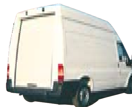
FORD TRANSIT Tetto rialzato Larghezza passaggio: 1198 mm Altezza passaggio: 1710 mm
