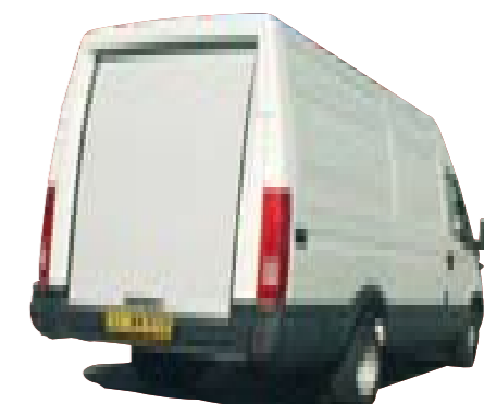
IVECO DAILY H2 Larghezza passaggio: 1260 mm Altezza passaggio: 1700 mm
